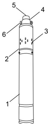
Насосы UNIPUMP серии ECO VINT — винтовые моноблочные насосы с корпусом из нержавеющей стали. На корпус насоса нанесен серийный номер, первые четыре цифры которого обозначают год и месяц его изготовления (ГГММ....).
