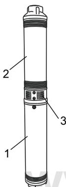
выполнены из высокопрочного, износоустойчивого поликарбоната. «Плавающие» рабочие колеса обеспечивают продолжительный срок службы гидравлической части и уменьшают вероятность заклинивания при перекачивании воды с механическими примесями.
